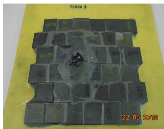
Figura 5 – Placa 1 após o ensaio balístico – vista frontal.
