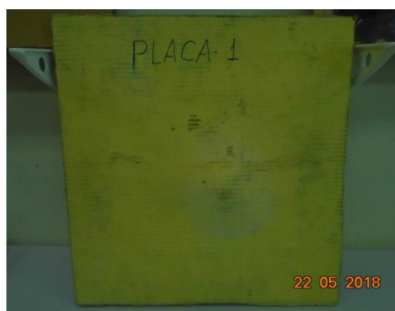
Figura 6 – Placa 1 após o ensaio balístico – vista traseira.
