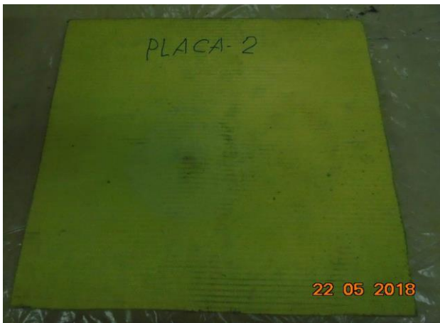
Figura 8 – Placa 2 após o ensaio balístico – vista traseira.
