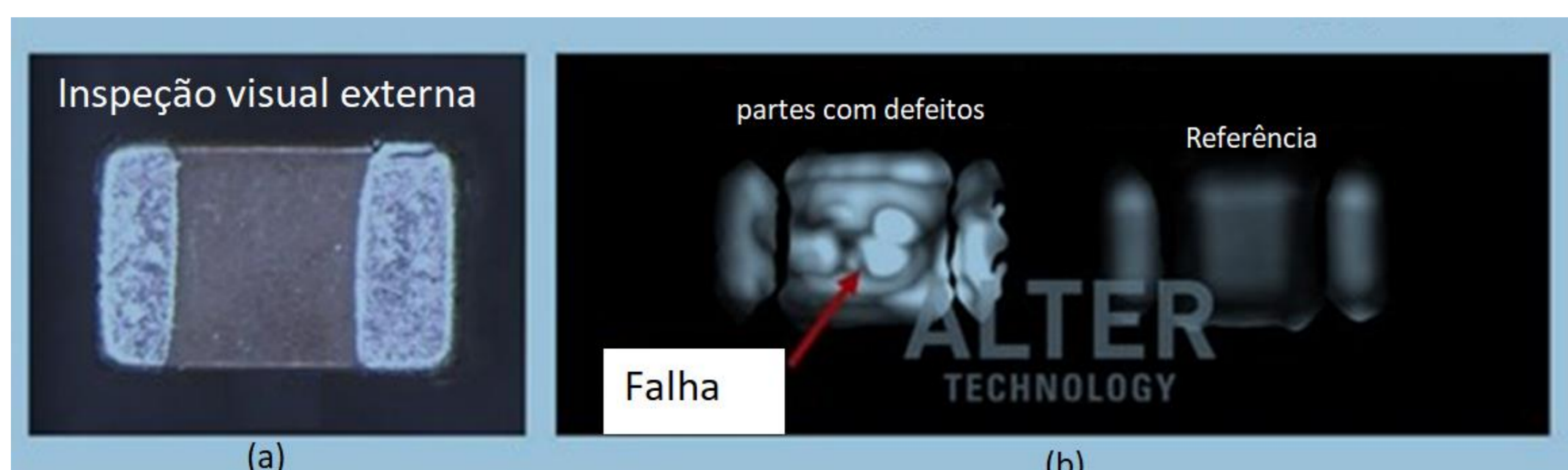
Figura 1 – Imagem obtida pela empresa Alter, a) inspeção visual externa e b) Imagem por SAM das partes com defeito e a referência [4].
