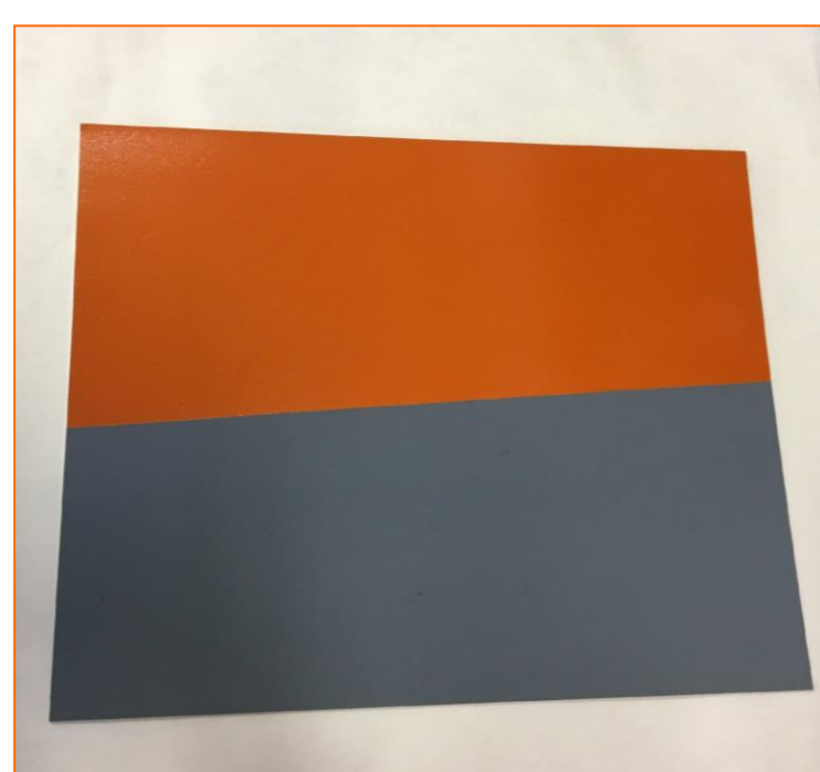
Fig 4 - Placa quadrada de alumínio com 350mm de lado e 2mm de espessura, revestida com as tintas Silver Metallic (FS 17178) e Laranja (FS 12215). Fonte: A autora.
