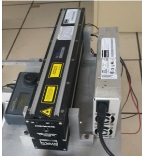
Fig. 2. Laser de CO 2 da marca Synrad, de 30 W, com potência ajustável.
