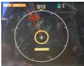
Fig. 13: Identificação do trigrama correspondente às ameaças CW2 e P01 do teste de detecção simultânea (um sinal pulsado junto a um sinal contínuo).
