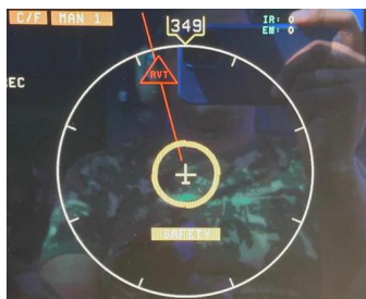
Fig. 12: Apresentação através do MFD do trigrama correspondente a emulação da ameaça RVT.
