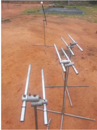
Fig. 4. Setup de ensaios de medida de pico de sobrepressão.
