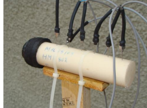
Fig. 3. Configuração de ensaio de medida de velocidade de detonação.
