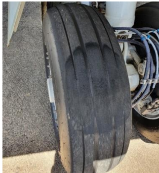
Fig. 6. Pneu da aeronave E-99 com desgaste prematuro provocado por intensa derrapagem.
